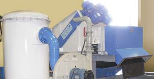
Escurredor vibrante con sistema de vacío
