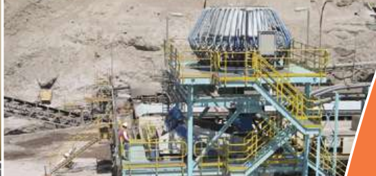
Filtración de estériles < 200µm. 150 t/h
